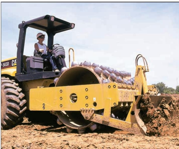
**Profil conique des pieds dameurs** de façon à ne pas altérer la partie supérieure de la couche.
